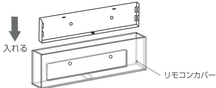
②リモコンハンガーとリモコンカバーを一緒に、壁にビスで取り付ける
