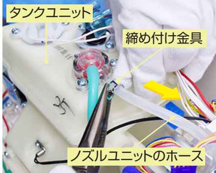
締め付け金具を緩めてノズルユニットのホースを抜く
