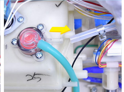
締め付け金具を緩めてノズルユニットのホースを抜く
